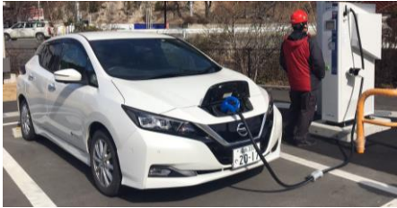
EV充放電器【葛尾村復興交流館あぜりあ】
